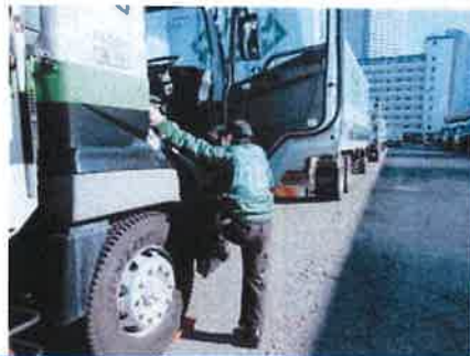
墜落・転落防止：三点支持の徹底
